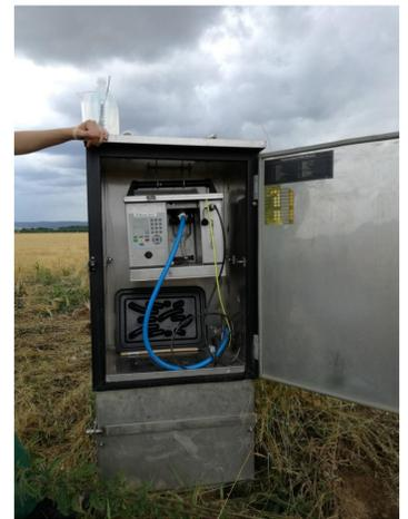
Eine automatisierte 24-h-Probenahme
